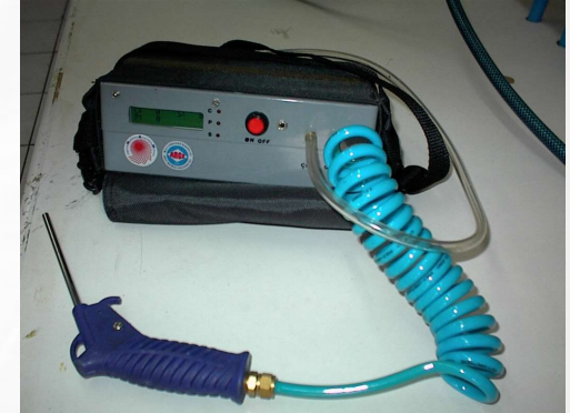
Klor ve fosfor grubu kirlenmeleri için ölçen ilk gaz sensör prototipi
