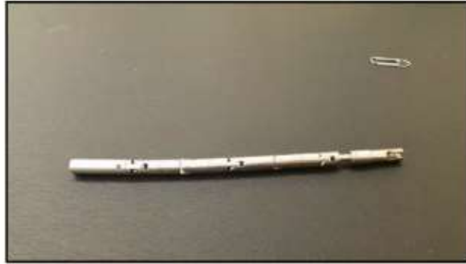
18.10.2016 tarihi itibarıyla 15,67 Ci aktiviteli Ir-192 radyoaktif kaynak bulunduran kaynak taşıyıcısı
