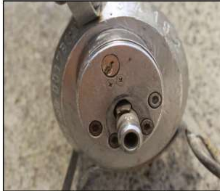
Gamagrafi cihazının kilit mekanizmasının görüntüsü
